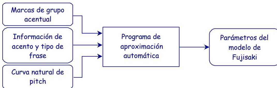
Figura 1: Estructura del proceso de etiquetado automático.
