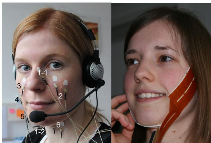
Figura 2.5: Disposición de sensores para sEMG. Fuente: [23]
